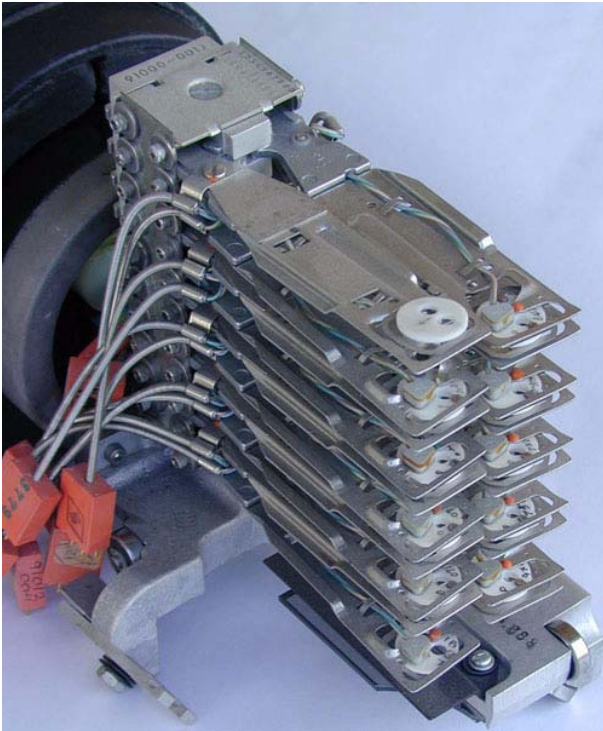
Abb. 10: Schreib-/Leseköpfe am Linearmotorantrieb der U8440
