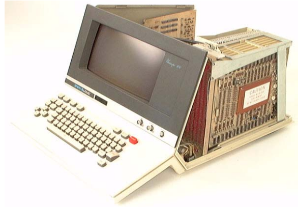
Abb. 26: UNISCOPE 100 – Blick auf die Elektronikplatinen: rechts außen Bildschirm-speicher in Ferriterkentechnik
