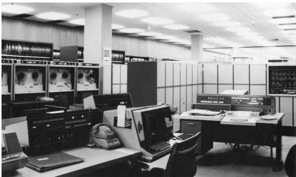
Abb. 30: Blick in den Maschinensaal: Im Vordergrund links die Konsole der U1108, rechts die Konsole der U418-III, dahinter links Magnetbandgeräte U16 und die Zentraleinheit der U1108
